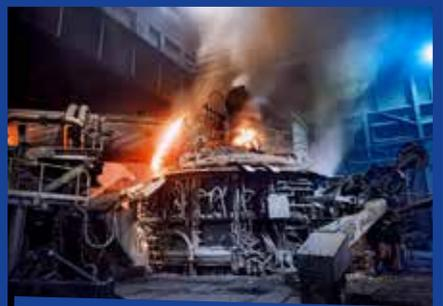
Ausschließlich Schrott wird im Lichtbogenofen eingeschmolzen, bei einer Temperatur von bis zu 1650 °
